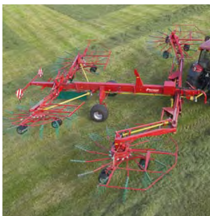
2bodová spodní agregace umožňuje natočení až s 90°úhlem.
