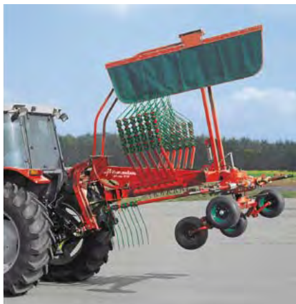
Pro snadnou manipulaci je řádkovací plachta na držáku s pružinou. Samotná řádkovací plachta je otočná s možností zavěšení do transportní polohy.
