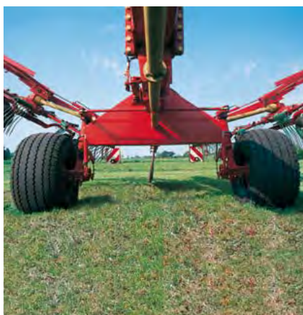
91150 C je na přání k dispozici s řízeným podvozkem. To je příspěvek k ještě větší manérovatelnosti a posílení stability na svazích.
