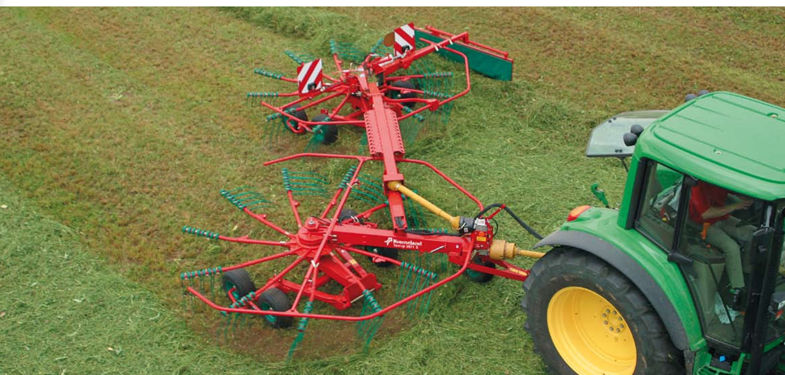
Stroje jsou vybaveny systémem rychlého zdvihu QuickLift. Tento systém řídí zdvih obou rotorů a umožňuje přizvednutí až o 50 cm na úvrati.
