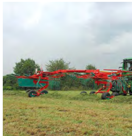
Stroje jsou vybaveny systémem rychlého zdvihu QuickLift. Tento systém řídí zdvih obou rotorů a umožňuje přizvednutí až o 50 cm na úvrati.
