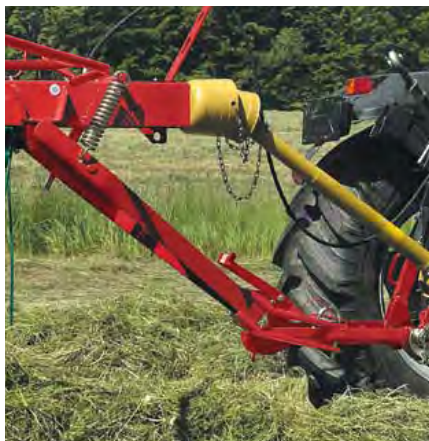
Oba typy jsou pro snadnou manévrovatelnost vybaveny homokinetickými kloubovými hřídeli.
