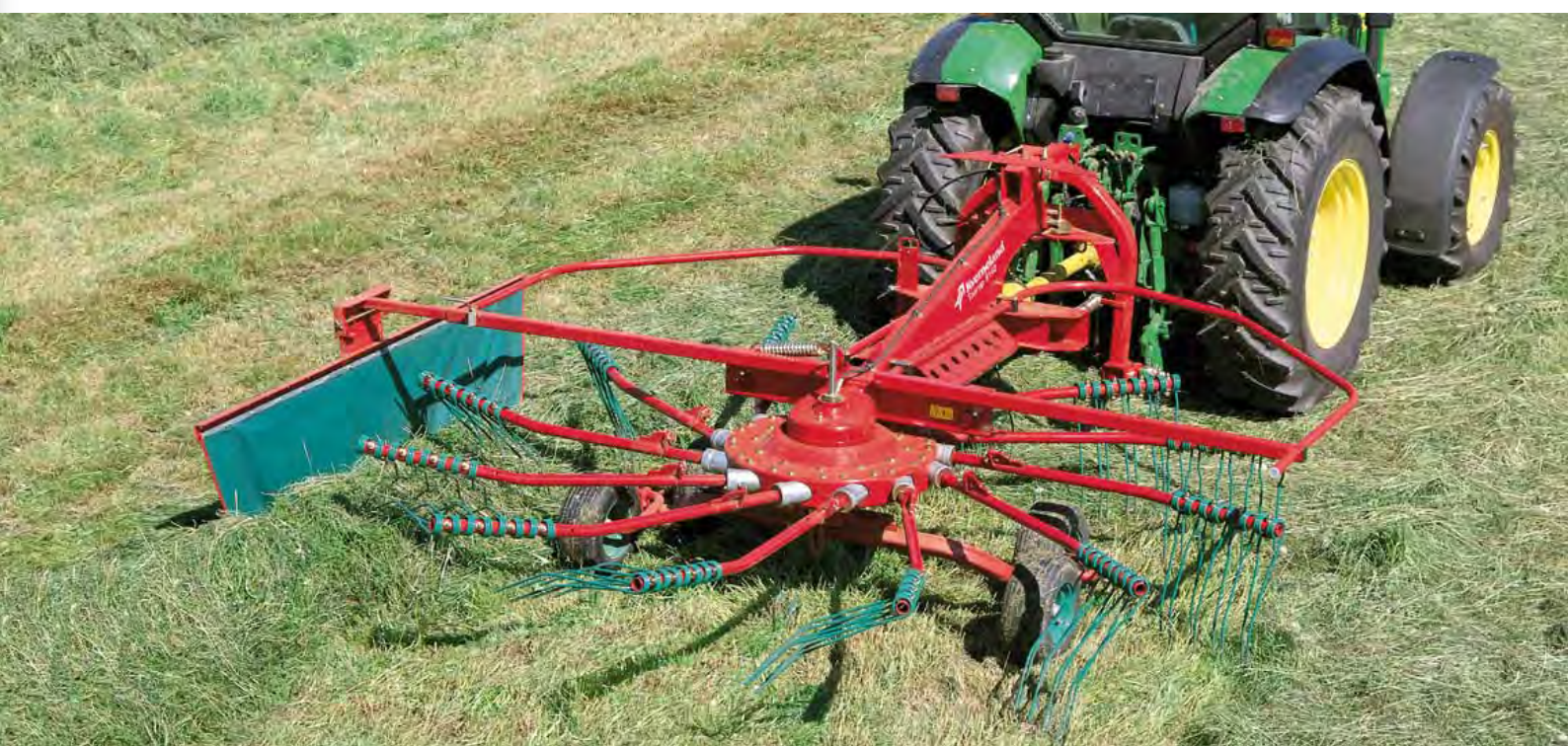
Pro snadnou manipulaci je řádkovací plachta na držáku s pružinou. Samotná řádkovací plachta je otočná s možností zavěšení do transportní polohy.
