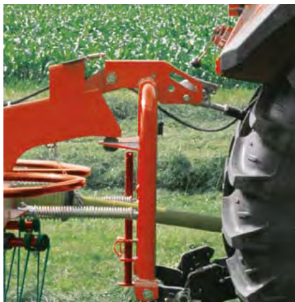
Sériově dodávaný tlumič vybrací pro optimální chování při tažení.
