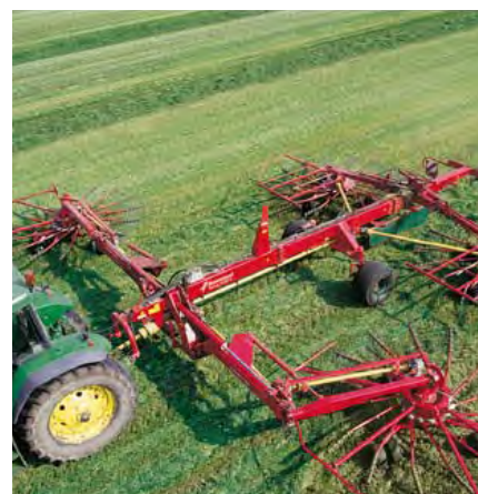
U každého rotoru si můžeme z kabiny nezávisle pomocí hydrauliky nastavit šířku a výšku.
