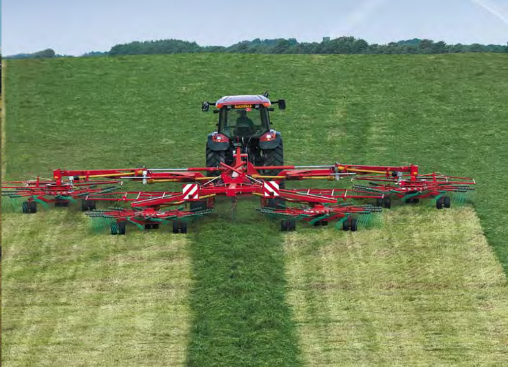
Hydraulicky nastavitelný pracovní záběr může být od 9,50 m do 15,00 m.
